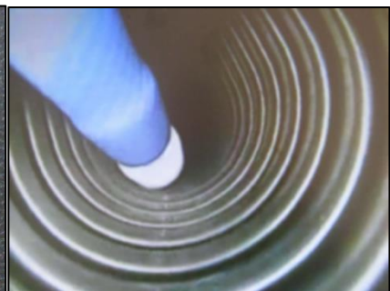
Abb. 3: technisch glatt: Pluggit-Kanal Rz < 15 µm
